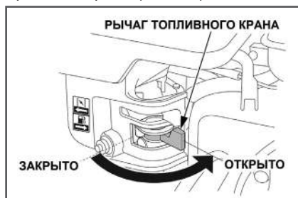
Рис. 11 Рычаг топливного крана
