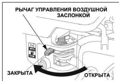
Рис. 10 Рычаг управления воздушной заслонкой
