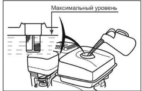
Рис. 6 Максимальный уровень топлива в топливном баке
