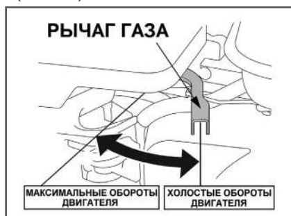
Рис. 12 Положения рычага газа
